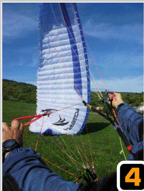
Schlangenbeschwörung gegen Starkwind: Der Wind kommt in unserem Beispiel etwas mehr von rechts als von hinten. Der Pilot hat den Schirm so auf den Boden gelegt, daß die rechte Kappenhälfte zuerst Luft schöpft. Mit dem rechten Tragegurt und der rechten Bremse ...
