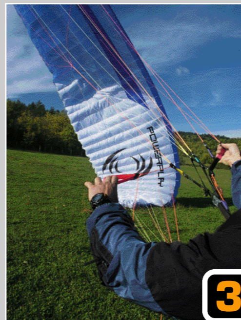
Schlangenbeschwörung gegen Starkwind: Der Wind kommt in unserem Beispiel etwas mehr von rechts als von hinten. Der Pilot hat den Schirm so auf den Boden gelegt, daß die rechte Kappenhälfte zuerst Luft schöpft. Mit dem rechten Tragegurt und der rechten Bremse ...
