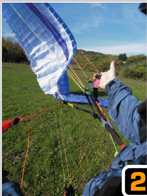
Schlangenbeschwörung gegen Starkwind: Der Wind kommt in unserem Beispiel etwas mehr von rechts als von hinten. Der Pilot hat den Schirm so auf den Boden gelegt, daß die rechte Kappenhälfte zuerst Luft schöpft. Mit dem rechten Tragegurt und der rechten Bremse ...
