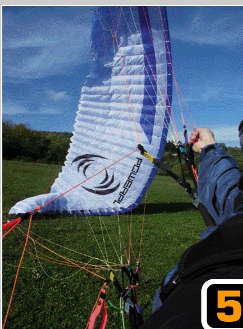
... wird der Schirm am Umschlagen gehindert und gleichzeitig dazu gebracht, am rechten Windfensterrand mit dem Stabilo voraus zu steigen. Kleine Schritte nach links verhindern ein Rückfallen der Kappe in die Powerzone. Wenn die „Kobra“ vom Boden abgehoben hat, läßt sich der Pilot darunter ziehen, dreht aus und ... hebt auch ab.
